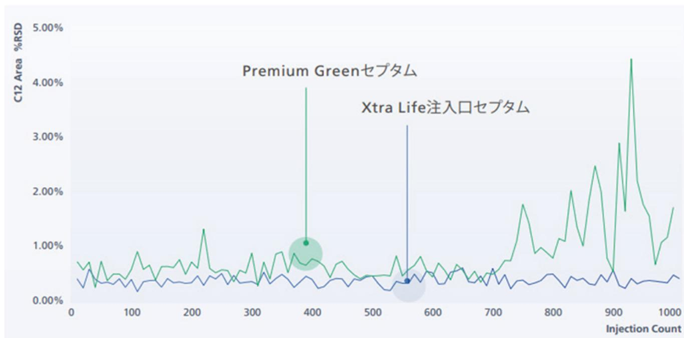
連続注入回数 1000 回時の Xtra Life 注入口セプタムとPremium Green セプタムの C12 面積再現性の比較
